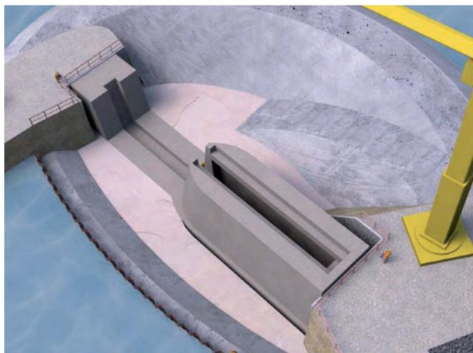
Pour faciliter les manœuvres de la porte, une souille, suffisamment profonde, sera édifiée pour la circulation du sable vaseux et un dispositif d'auto-évacuation est prévu.
