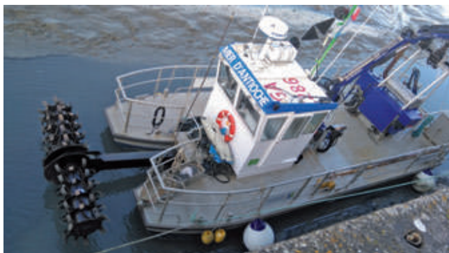
Le « roto dévaseur » à quai
