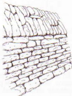
Traitement de tête de mur au nord de l'île par pierres plates inclinées
